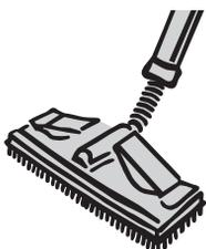
Utilizá-lo como um escovão normal; o vapor dissolverá a sujeira que permanecerá no pano. O cabo do escovão pode ser articulado em 90°, para girar à direita e à esquerda.
