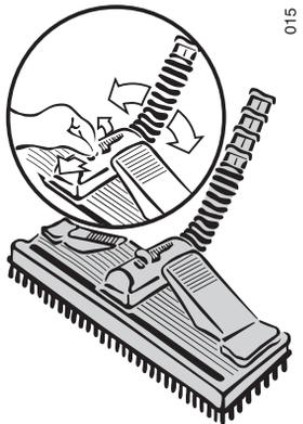
Gelenkig machen Sie den Griff, indem Sie die Lasche anheben und in die angezeigte Richtung ziehen, um den Griff freizusetzen. Um den Griff festzusetzen müssen Sie: den Griff in die vertikale Position bringen die in der Abbildung beschriebene Prozedur umgekehrt ausführen.
